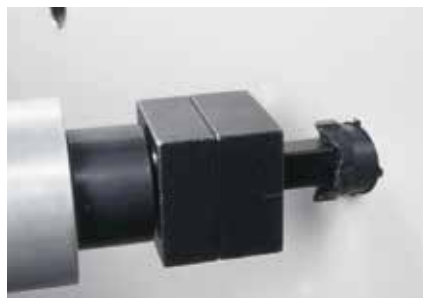
Перфоформы Greenlee облегчают операции выдавливания отверстий с различными профилями и размерами.
