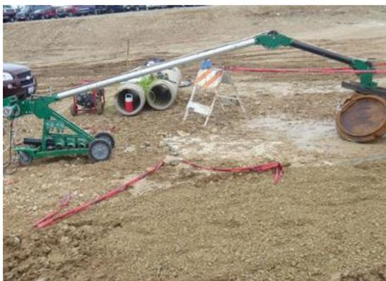
Двухскоростной двигатель, обеспечивающий самое быстрое время тяги для всех потребностей тяги в самом широком диапазоне (10000 фунтов)
